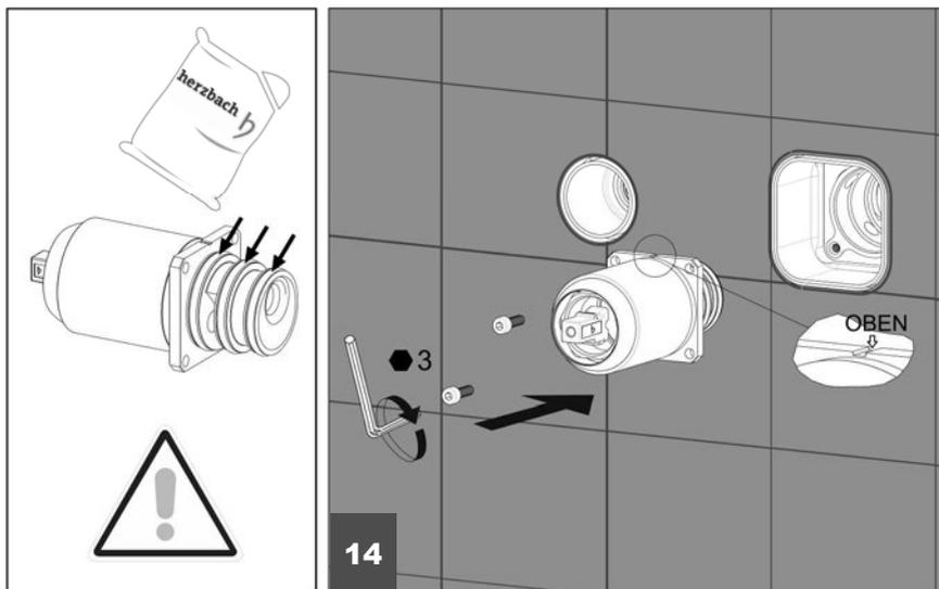
**Montagehinweis: Vor dem Einbau der Mischereinheit die O-Ringe mittels beiliegendem Armaturenfett einfetten!**
