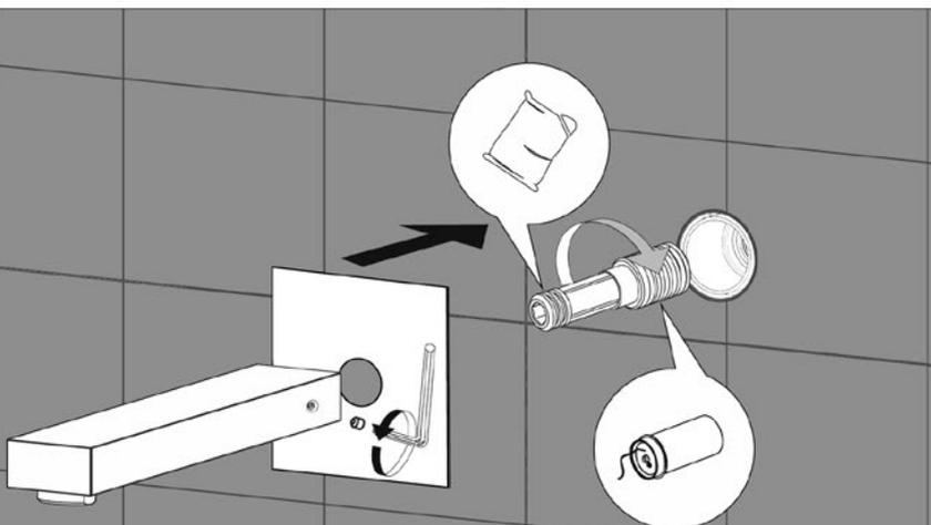
**Montagehinweis:** Bei Ausläufen mit Montageadapter zuerst Adapter montieren, danach die Auslaufblende aufsetzen.
