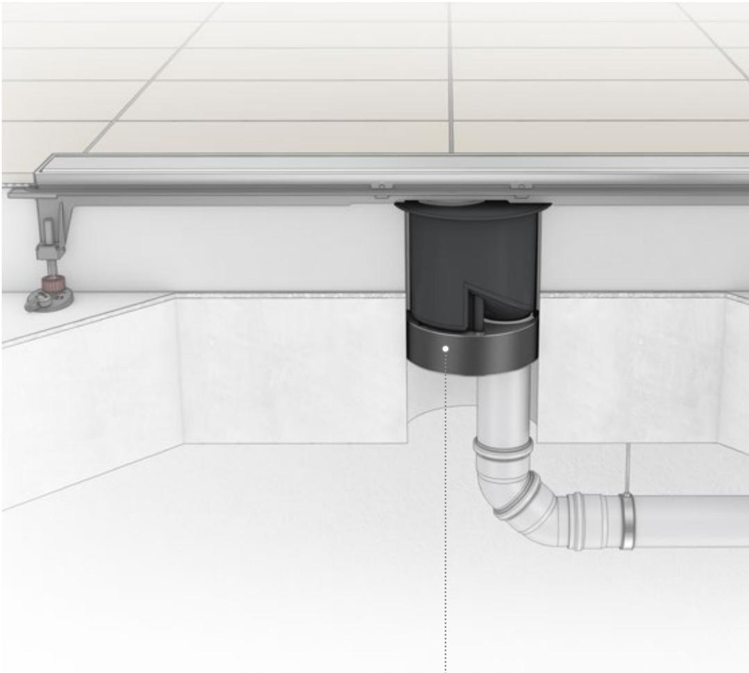
Bei Feuer dehnt sich das intumeszierende Material der Brandschutzmanschette aus und verschließt den Ablauf sicher gegen Feuer und Rauch.
