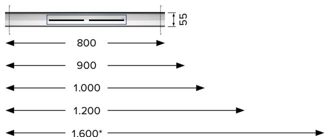
\* TECEdrainprofile in 1.600 mm Länge ist nur in der Ausführung Edelstahl gebürstet erhältlich.
