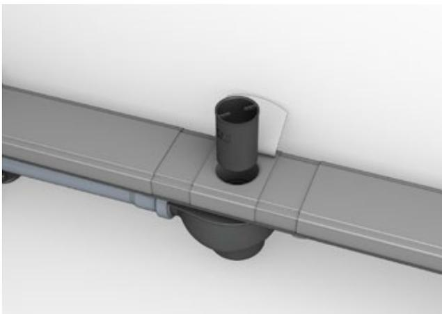
**Schritt 2:** Dichtigkeitsprüfung durch den Installateur: In die Öffnung des transparenten Rohbauschutzes wird das Tauchrohr eingesetzt.
