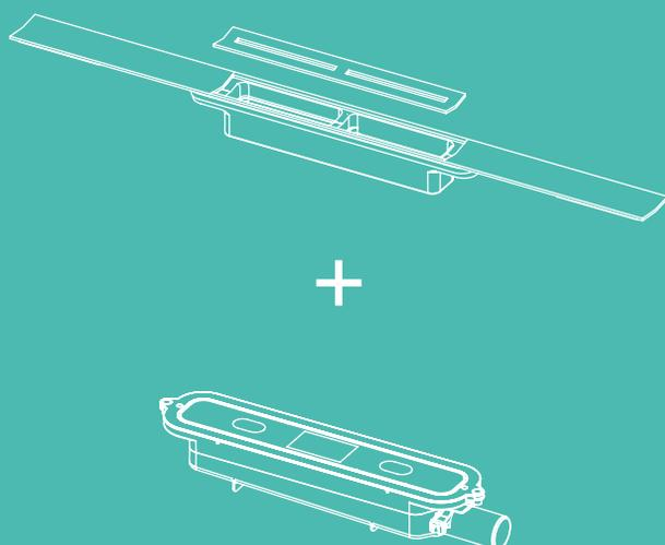
Individuell kombiniert: Die Duschrinne TECEdrainline besteht aus einem Rinnenkörper in verschiedenen Ausführungen, einer Abdeckung aus Glas oder Edelstahl oder einem Träger bzw. einer Mulde für Naturstein oder Fliese und einem von fünf Abläufen. Alle Elemente können separat bestellt und frei miteinander kombiniert werden.
