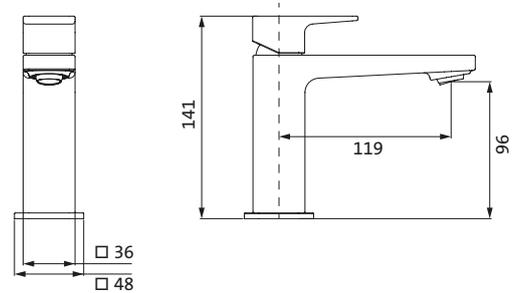
Lochbohrung  $\varnothing$  35 mm
