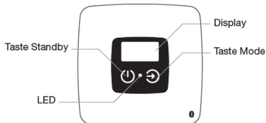
Das Gerät kann mit den beiden Tasten bedient werden, die sich am Gerät befinden, oder mit der App, die aus dem Store heruntergeladen werden kann. Das Display zeigt den Stromverbrauch des aktuellen Tages.
