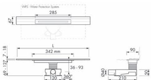
**R-line Waterstop | Sperrwasserhöhe 50 mm**
