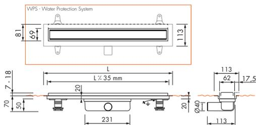
**Modulo Clean 50 / Wall | Sperrwasserhöhe 50 mm**
