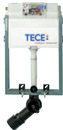
TECEbox- Nassbau-Spülkasten Bauhöhe 1060 mm, für den Einbau in eine gemauerte Vorwand vor einer Massivwand, Betätigung von vorne. Best.-Nr. 9.370.000
